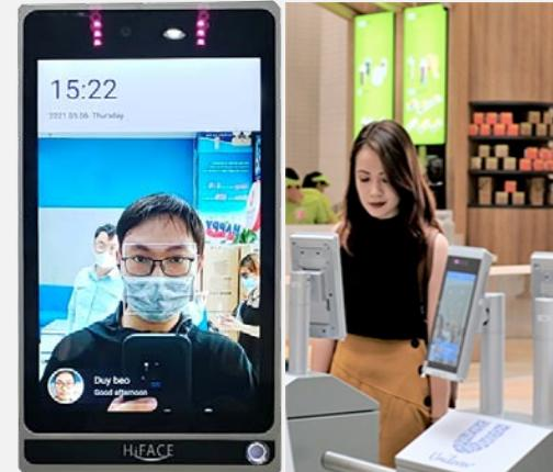
HiFace và HiFace+ (với máy ảnh nhiệt để kiểm tra thân nhiệt)
